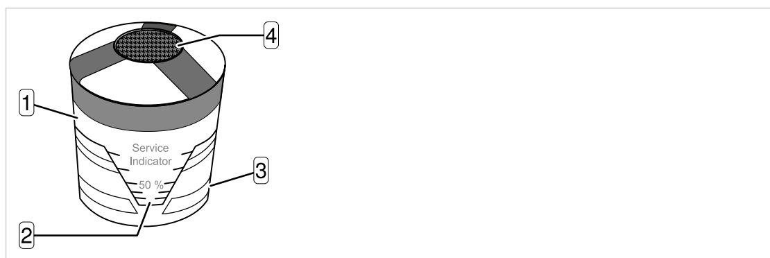
Joon. 71 Kompressori õhufiltri sissetõmbe õhutoru tehnohoolduse näidiku kontrollimine
